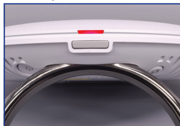
Fig. 2: LED rojo. El amplificador ya se puede configurar.
