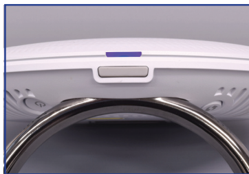
Fig. 4: LED violeta. El amplificador está en proceso de sincronización.
