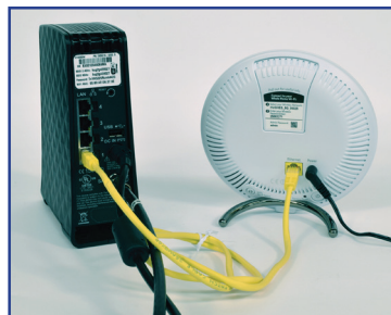
Fig. 3: Conecte el amplificador al módem HT2000W.
